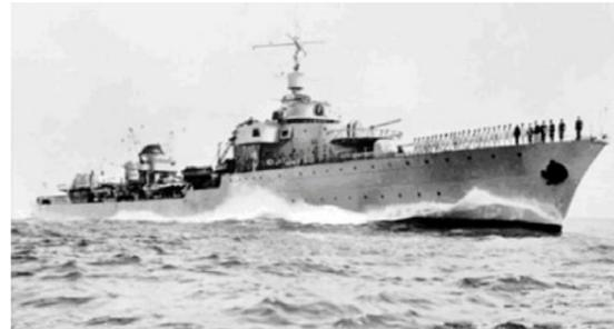
*Le Triomphant* (3 200 t, 132,4 m de long par 12,3 m de large, 5 m de tirant d'eau, vitesse 43 nœuds) dispose d'un équipage de 13 officiers et 197 hommes (coll. FFL).
