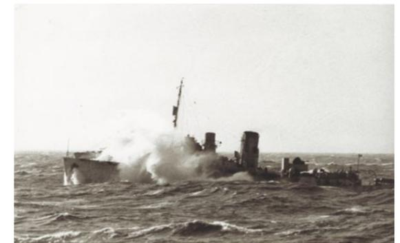
Une corvette FNFL, 1 380 t, 62,5 m de long sur 10 m de large, 5 m de tirant d'eau, vitesse : 16 nœuds (coll. FFL).
