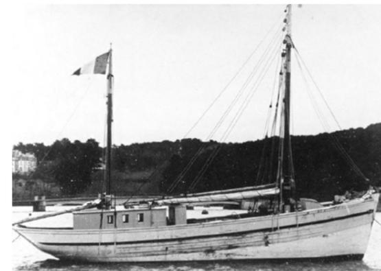
*Ar Zénith* : bateau de charge, bateau à passagers de type dundée, à coque en bois long de 20 m (© AFL Ar Zénith).
