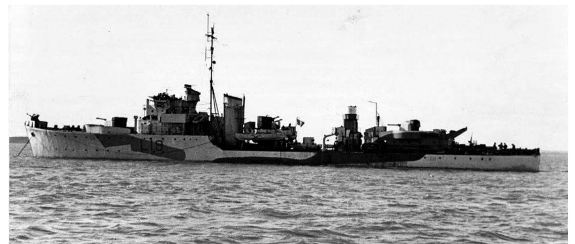
*La Combattante* (1 300 t, 85 m de long x 10 m de large, 3,6 m de tirant d'eau, 28 nœuds) est armée de 4 canons de 102 mm, 4 de 40 mm, 6 de 20 mm, 2 grenadeurs et 4 mortiers. Elle est dotée de trois radars et d'un ASDIC (coll. FFL).
