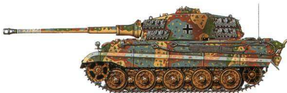
Tiger II tourelle Henschel. Seulement utilisé en Normandie par la Sw Pz Abt 503 il sera en revanche plus présent au cours de la Bataille des Ardennes. Armé du puissant canon Pak 43 de 88 mm, il sera en revanche désavantagé par sa consommation en carburant hors normes : 600 litres aux 100 kms et surtout par son gabarit restreignant singulièrement ses déplacements en terrain encaissé ! (DR)
