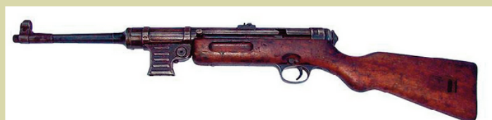
MP-41. On remarque l'ensemble en bois (servant à la fois de crosse et de fût), l'absence d'ergot sous le nez du canon (contrairement à la MP-40), et le sélecteur de tir au-dessus de la détente. Néanmoins, la parenté avec la famille des MP-40 est visuellement indéniable !
