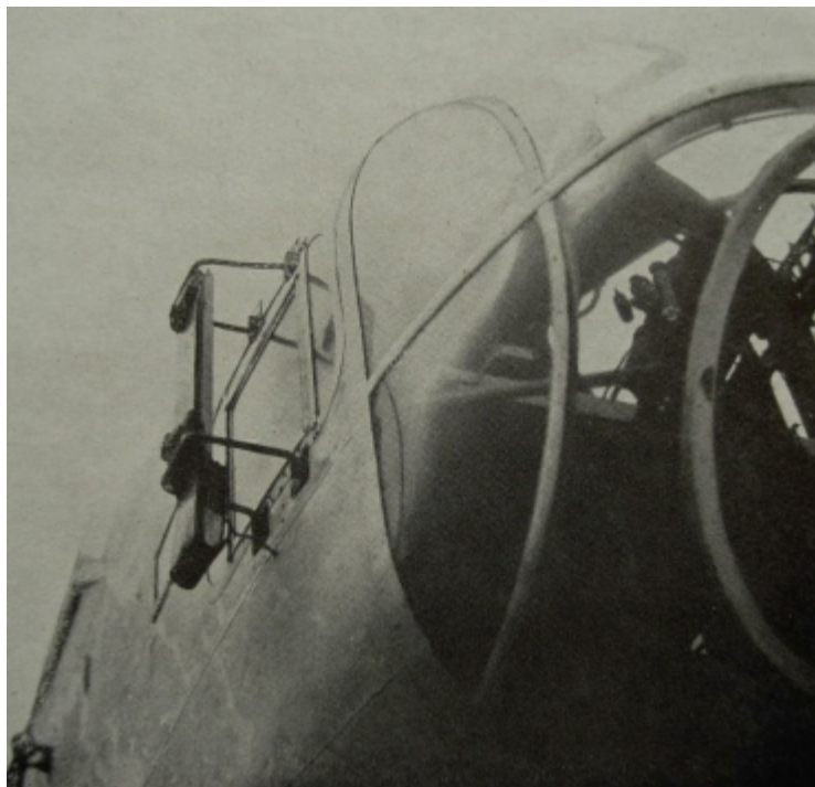
PSYCHROMÈTRE MK II SERVANT À MESURER LE TAUX D'HUMIDITÉ DE L'AIR INSTALLÉ SUR LE NEZ D'UN HALIFAX.
